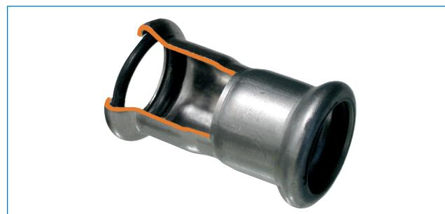
В пресс-фитингах есть карман, в который до упора вставляются концы трубы. Прессовочная машина оснащена обжимными челюстями профиля M с соответствующим размером, который деформирует контролируемым образом конец фитинга на трубе, предотвращая скольжение и провороты в работе под давлением.
